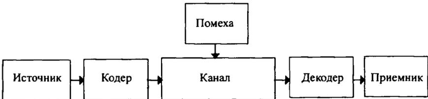
Рис. 25. Обобщенная схема радиоэлектронной системы
