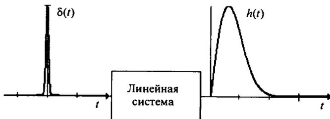
Рис. 12. К введению понятия импульсной характеристики линейной системы
