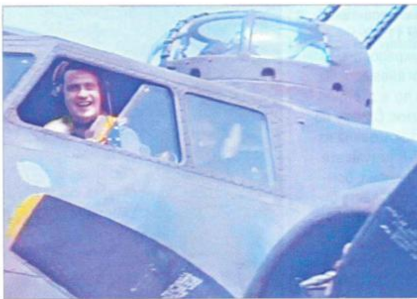
Командир экипажа капитан Морган. Видна верхняя турель бортинженера. Светло-зеленое пятно под открытой форточкой – заплатка, которой заделали пробойну и покрасили краской другого оттенка
