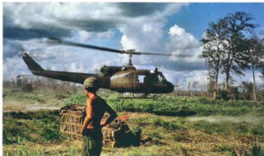
Вертолет УН-1В армии США в Южном Вьетнаме. Начало 1960-х гг. На вертолет нанесены слабоконтрастные опознавательные знаки и надписи.
