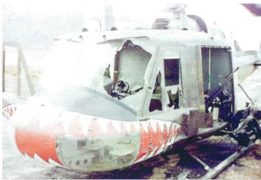
Типичные боевые повреждения вооруженного УН-1В армии США. Южный Вьетнам, середина 1960-х гг.
