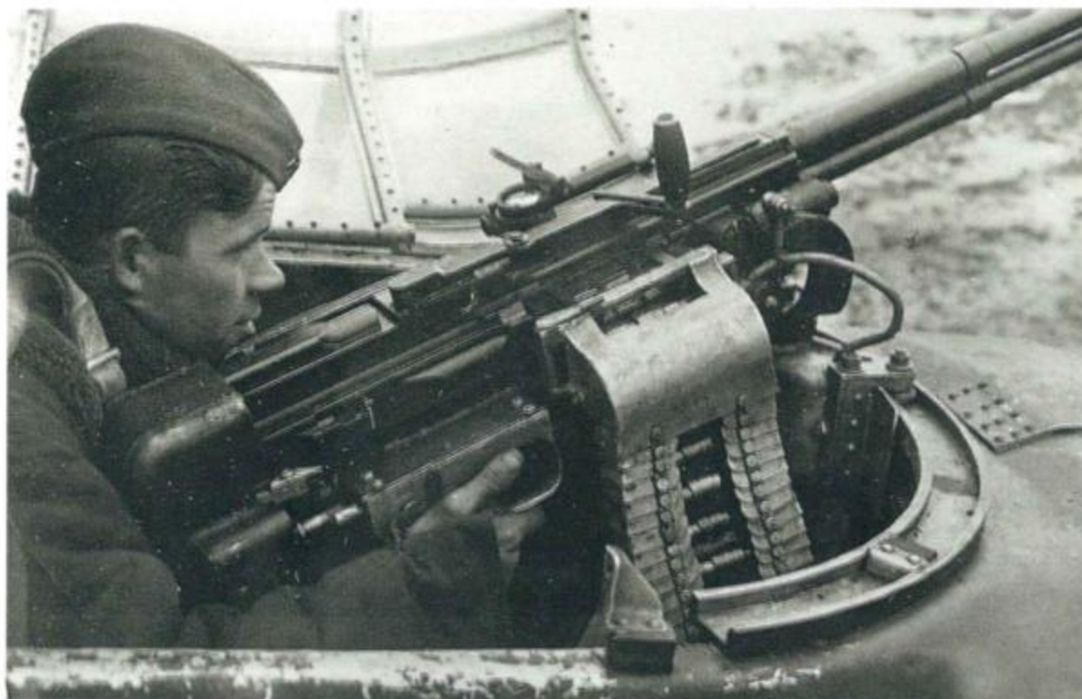
Оборонительная установка ВУБ-3 с пулеметом УБТ на самолете Ил-2 №30928 в ходе государственных испытаний на НИПАВ ВВС, октябрь 1942 г. Кабина воздушного стрелка оказалась слишком тесной. Стрелок в меховом комбинезоне и с парашютом с трудом размещался между пулеметом и задней бронеплитой корпуса
