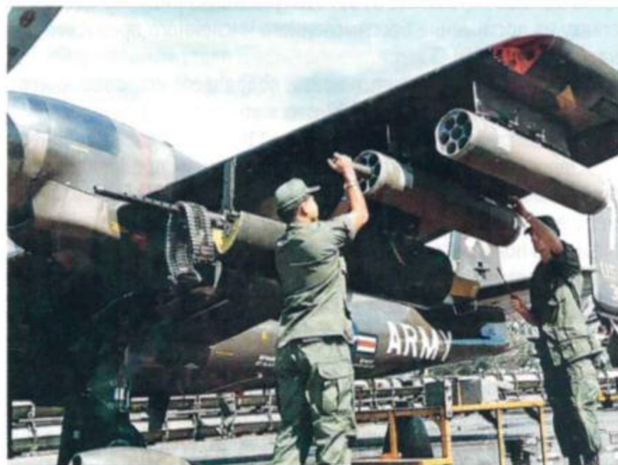
Заряжание блоков НАР на самолете JOV-1/OV-1 «Мохawk». Авиабазы Ня Транг
