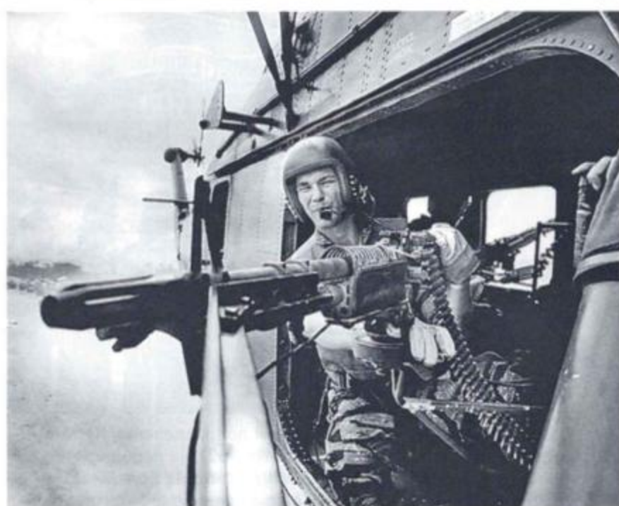
Самодельная бортовая турель с пулеметом М60 на вертолете CH-34/HUS-1 КМП США, 1963–1964 гг.
